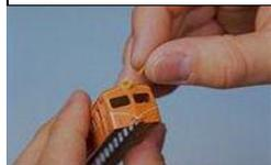
写真のようにヘッドライトなどの突起物だけを覆う場合にも細く切ったテープは有効です。いずれの場合も、細く切ったテープはマスキング部の縁に使うこととなります。そして、その縁を元に残った部分を覆うようにします。手間のかかる作業ですが、仕上がりを考えるなら多少の遠回りは覚悟しましょう。ていねいに行なえるか否かによって完成度は変わってきます。集中力の持続が大切な、慎重に行ないたい作業です。
